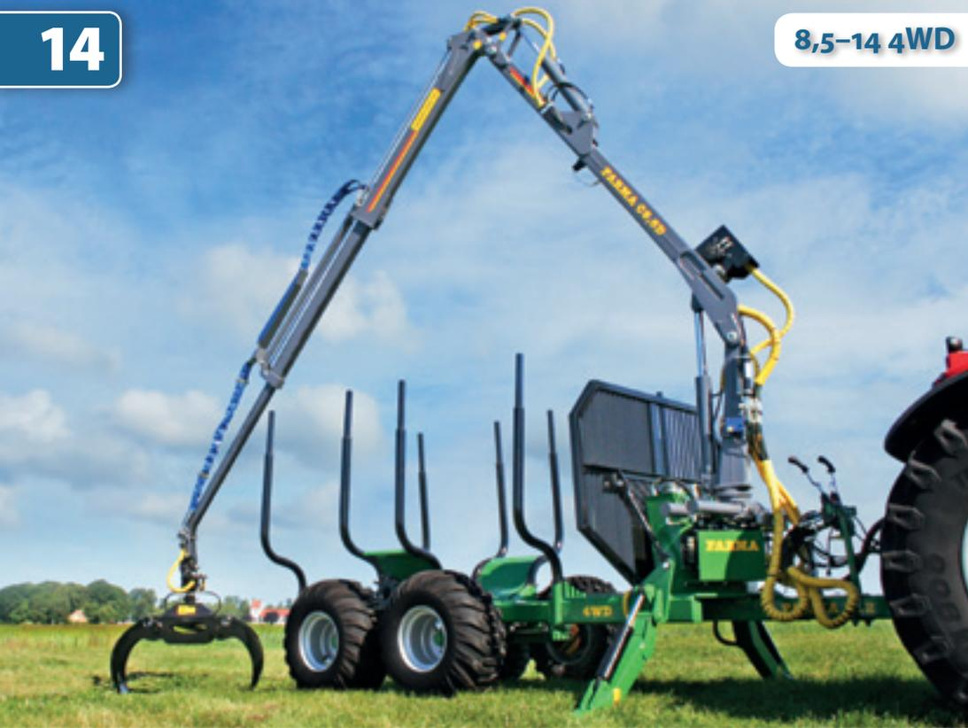
Seit mehreren Jahren gehört zum FARMA-Sortiment auch der T14 4WD. Ein bewährter, gut ausgestatteter, wendiger Holzrückewagen mit eigenem Antrieb, niedrigem Schwerpunkt und Deichsellenkung für gute Geländegängigkeit. Der Rückewagen besitzt u.a. Scheibenbremsen an zwei Rädern sowie eine um 50 cm hydraulisch verschiebbare Doppelachse. Weitere Informationen zu diesem Modell können der Website sowie der Übersicht und den technischen Daten in dieser Broschüre entnommen werden.
