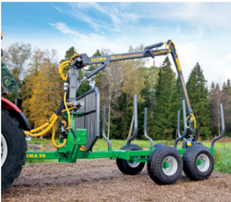
Der FARMA Holzrückewagen CT 5,1-8 verfügt standardmäßig über hydraulische Stützbeine, 3 Rungenbänke und Bereifung 400/60 15,5. Wie aus der Abbildung hervorgeht, sind die Stützbeine vor dem Gitter in ausgeklappter Form gut geschützt.
