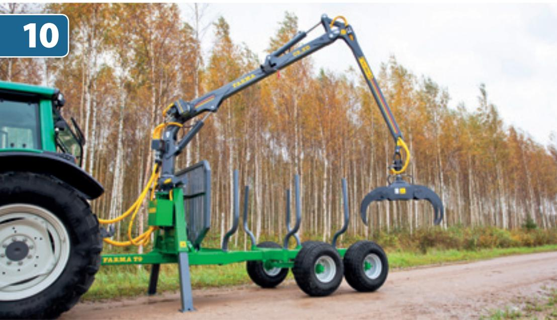
Die Abbildung zeigt den C 5,3 G2 auf einem 9-Tonnen-Rückewagen. Das Gespann ist zusätzlich mit einem „Leichtgewichtventil“, Kranbeleuchtung und funkgesteuerter Winde ausgestattet.
