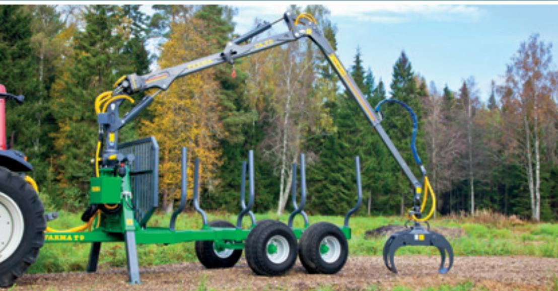
Die Abbildung zeigt den C 6,3 G2 mit Einfachteleskopfunktion auf einem 9-Tonnen Rückewagen. Das abgebildete Gespann ist zusätzlich mit funkgesteuerter Winde, Niederdruckservo zur Steuerung des Krans, Kranbeleuchtung sowie Rahmenverlängerung mit montierter Fahrzeugbeleuchtung ausgestattet. Standardmäßig ist der Rückewagen mit 3 Rungenbänken ausgestattet.
