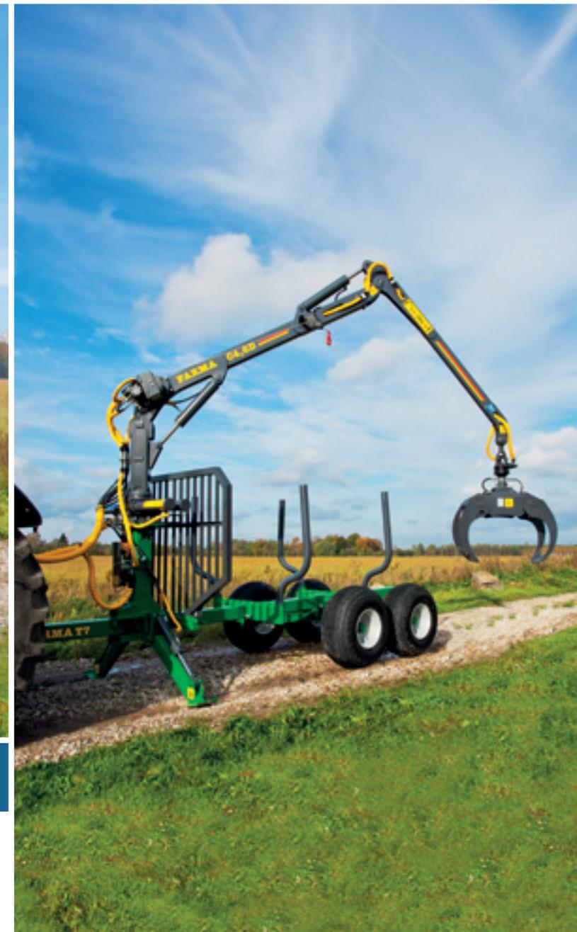
Der FARMA CT 4,6D-7 ist unser kleinster Holzrückewagen mit Deichsellenkung. Durch die Deichsellenkung ist der Wagen deutlich beweglicher und das Risiko von Schäden am nachwachsenden Wald geringer.
