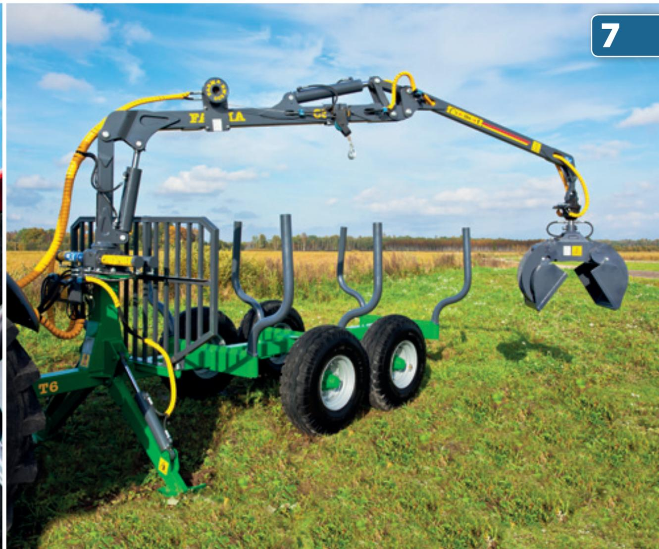
Der verwendete Werkstoff und die sonstigen Eigenschaften des Krans haben den Kran schnell zum Favoriten unter den kleineren Forstmaschinen gemacht. Der abgebildete Wagen ist zusätzlich mit einer Rahmenverlängerung, funkgesteuerter Winde und Einsatzschaufel im Greifer des Krans ausgestattet.
