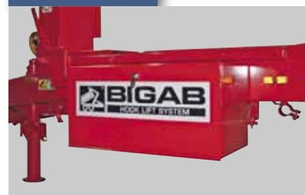
Mit dem seitlich am Rahmen montierten, verschließbaren Werkzeugkasten sind die verschiedensten Arbeits- und Hilfsmittel, z. B. Spanngurte, schnell griffbereit. Verschiedene Modelle können auf Wunsch auch mit mehreren Werkzeugkästen ausgerüstet werden.
