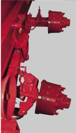
Gefederte BIGAB Hakenliftanhänger werden mit Nachlaufachsen oder Achsen mit Zwanglenkung angeboten. So wird die Abnutzung der Reifen und des Untergrundes gesenkt, während sich gleichzeitig die notwendige Zugkraft verringert.
