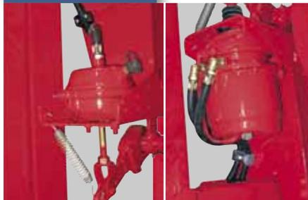
BIGAB bietet verschiedene Bremsalternativen zur optimalen Abstimmung auf Ihre potenzielle Zugmaschine. Wir führen Hydraulikbremsen, Druckluftbremsen (Positiv-/Negativsystem) sowie eine kombinierte Luft-Hydraulik-Bremse. Die Abbildung zeigt die Druckluftbremse.
