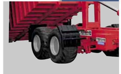
Wenn Sie Ganz- oder Halbkotflügel für Ihren Hakenliftanhänger wünschen, können Sie sich je nach Modell und Radausführung zwischen verschiedenen Alternativen entscheiden. Mit Kotflügeln sinkt der Verschmutzungsgrad Ihres Anhängers, insbesondere bei Fahrten ohne Container, da so der Schmutz direkt abgefangen wird.
