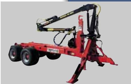
Wenn Sie einen BIGAB mit Kran brauchen, finden Sie bei uns verschiedene Optionen: Zum einen die hier abgebildete Variante und zum anderen einen Kran, der vor dem Hakenarm eingeklappt werden kann. Für eine enorme Arbeitserleichterung sorgt die Kranfernsteuerung.
