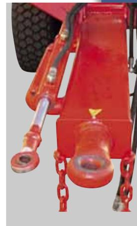
Unser Angebot umfasst auch zwangsgelenkte Achsen, die den Lenkeinschlag der Zugmaschine über Hydraulikzylinder automatisch übernehmen – eine hervorragende Option, wenn eine präzise Lenkung des Anhängers notwendig ist. Für diese Funktion ist eine entsprechend geeignete Zugmaschine notwendig.
