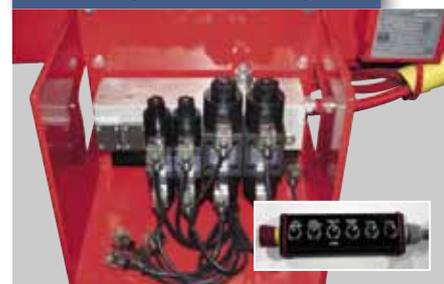
Ein elektrisch angesteuertes Ventil mit Anschlussmöglichkeiten für sechs doppelt wirkende Funktionen reduziert die Anzahl der zur Zugmaschine führenden Schläuche. Die Steuerung erfolgt über ein Steuerpult im Fahrerhaus. Druck und freier Rücklauf erforderlich. Einfache Anpassung an LS-Systeme.
