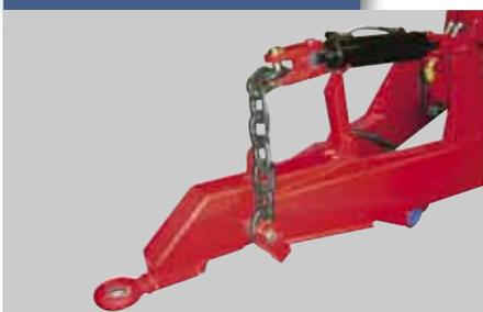
Um zu vermeiden, dass die Zugmaschine beim Containerwechsel angehoben wird, greifen wir auf zwei verschiedene Hilfsmittel zurück. Das sind die hydraulische Fahrwerkssperre für das mechanische Pendelfahrwerk einerseits und eine hydraulische Rahmensicherung andererseits. Die Abbildung zeigt eine hydraulische Rahmensicherung.
