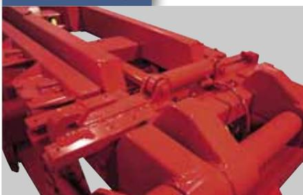
Der BIGAB verfügt standardmäßig über eine mechanische Containersicherung, kann jedoch optional mit einer hydraulischen Containersicherung ausgestattet werden, die den Container so fixiert, dass er fest auf dem Rahmen sitzt. Die Abbildung zeigt die hydraulische Containersicherung.
