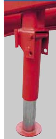
Stützfüße werden in drei Ausführungen angeboten: Eine einfache Lösung ist die Stütze, bei der die Höhe durch Einschieben eines Splints in die entsprechenden Löcher reguliert wird (für Zugmaschinen mit höhenverstellbarem Zughaken), eine Hydraulikstütze, die über einen einfach wirkenden Hydraulikanschluss betrieben wird, sowie die Kurbelstütze für Anwendungen, bei denen die Höhe an die Zugmaschine angepasst werden muss. Die Abbildung zeigt einen hydraulischen Stützfuß.
