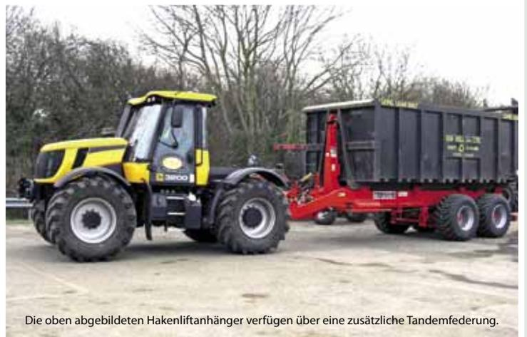
Die oben abgebildeten Hakenliftanhänger verfügen über eine zusätzliche Tandemfederung.
