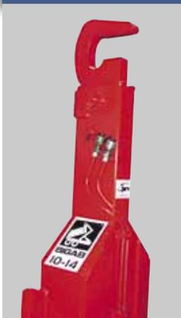
Ein nützliches Ausstattungsdetail für Container mit hydraulischer Heckklappe, bei denen die Klappe beim Containerwechsel angesteuert werden soll. Die Schläuche werden mit dem Container auf den Boden abgesenkt, so dass Sie beispielsweise Ihren Minibagger einfahren, die Klappe schließen und den Container wieder aufladen können.
