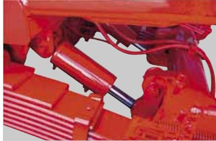
Bei den meisten Hakenliftanhängern können Sie aus verschiedenen Hydraulikoptionen für die Fahrwerksregulierung auswählen, die beispielsweise auf sensiblen Untergrund und beim Wenden gute Dienste leisten. Achtung: Die Fahrwerksregulierung darf nur bei unbeladenem Anhänger verwendet werden.
