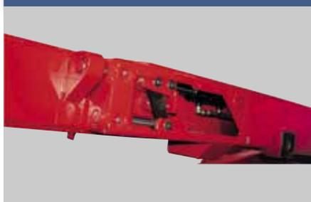
Zu unseren Ausrüstungsoptionen zählt auch die hydraulische Ansteuerung des Kipp- und Auf-/Absatzbetriebs für die Modelle, bei denen sie nicht zum Standard gehört. Wählen Sie diese Funktion, wenn Sie in der Zugmaschine zwischen Kippen und Auf-/Absetzen wählen wollen.
