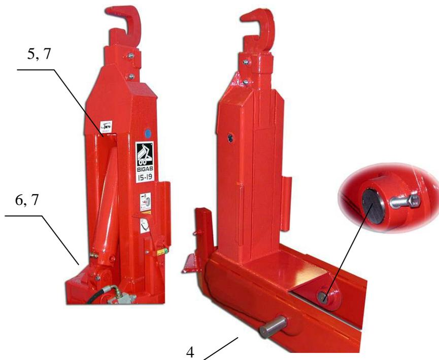
Abb. 43. Ausklappbarer Hakenarm
