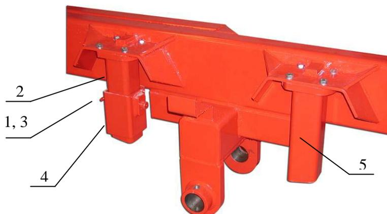
Abb. 45. Fahrwerksblockierung
