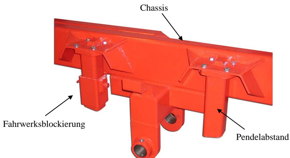
*Abb. 13. Fahrwerksblockierung*
