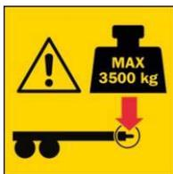
Abb. 26. Maximaler Druck an der Zugöse
