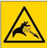
*Abb. 22. Unter Druck stehendes Hydrauliköl*
