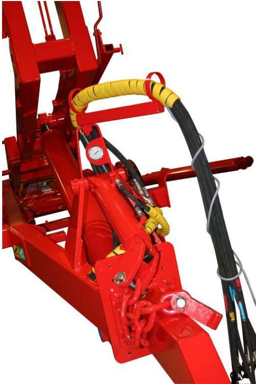
Mit dem hydraulischen Rahmenschloss wird der Rahmen bei einer Nutzung der Wechselfunktion arretiert. Per Manometer wird die Zugkraft des Zylinders angezeigt. Im Lieferzustand ist das Manometer auf 100 Bar eingestellt, muss jedoch entsprechend der Traktorgröße justiert werden.
