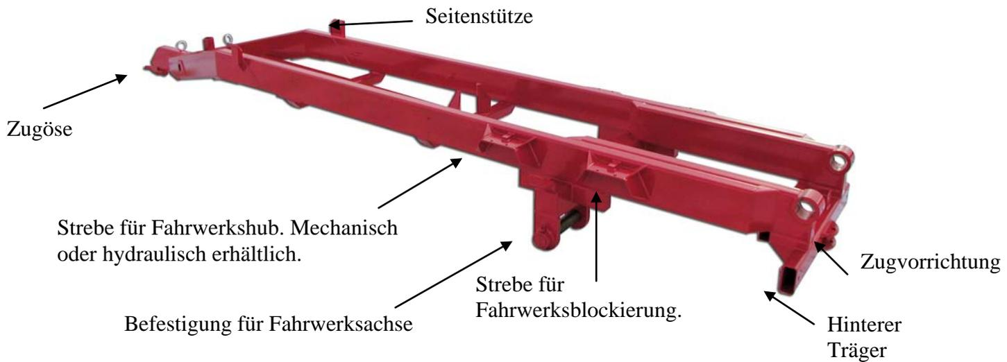
Abb. 2a. Chassis mit Fahrwerksblockierung
