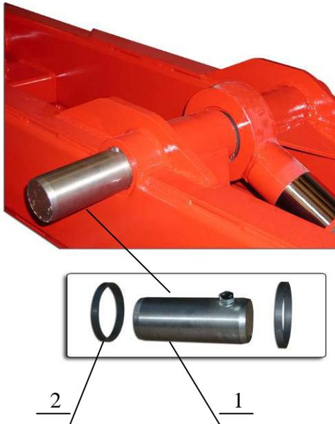
Abb. 41. Zylinderhalterung
