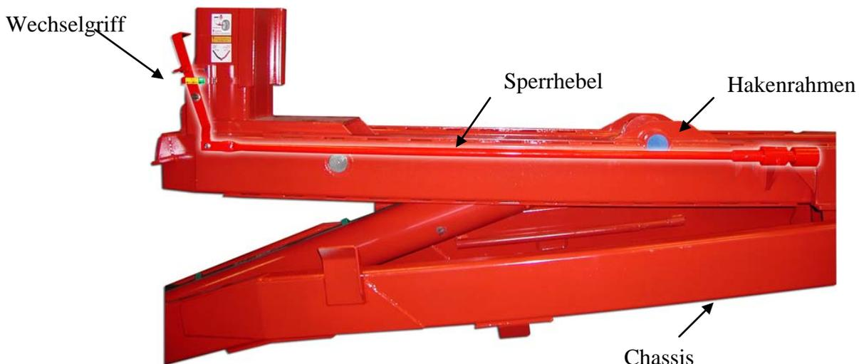
Abb. 8. Wechseinheit
