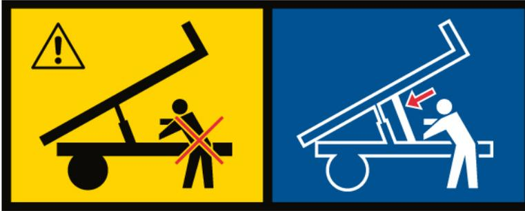
Abb. 24. Sicherheitsstütze bei allen Servicearbeiten verwenden!
