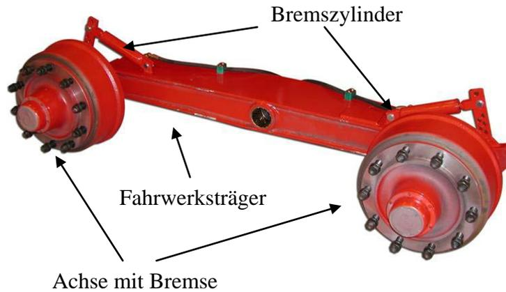
*Abb. 5. Fahrwerk*
